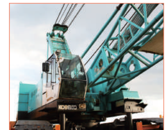
90tクローラークレーン
